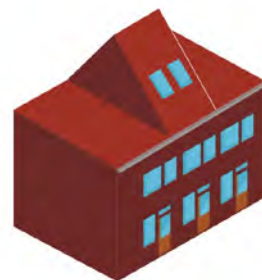
Dakopbouw op plat dak met de nok evenwijdig aan de gevel
